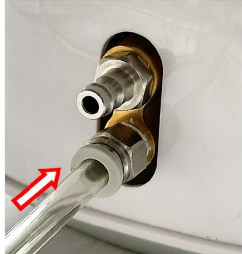
**Шаг 3: Подключите выпускную трубку высокого давления:** Смонтируйте трубку в соответствии с вашей схемой расположения. Убедитесь в надёжном креплении всех соединительных компонентов труб, чтобы избежать утечки или повреждения. Обычно используют нейлоновые трубы.
