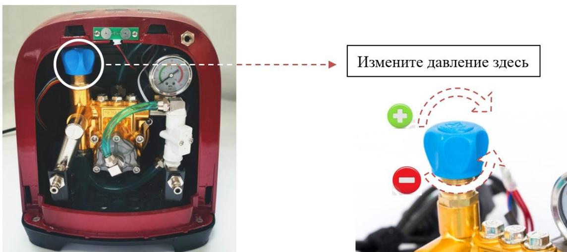
Пожалуйста, отрегулируйте клапан давления и установите рабочее давление оборудования в диапазоне от 4 до 7 Мпа (наилучшее рабочее давление - от 5 до 6 МПа).
