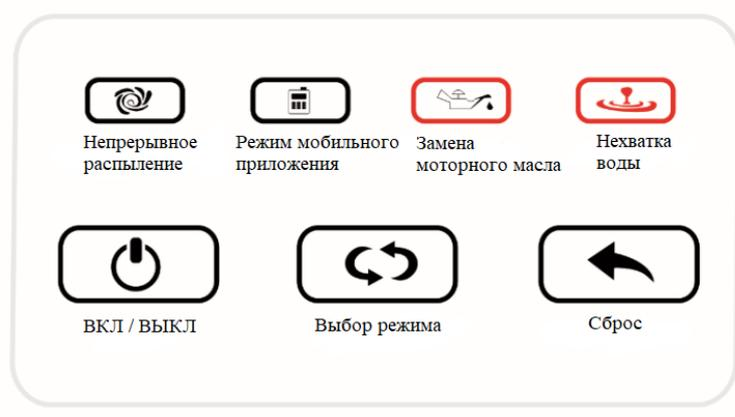
1. **Кнопка включения и выключения:** мигает, когда аппарат не работает, и горит, когда туманообразователь включен;
